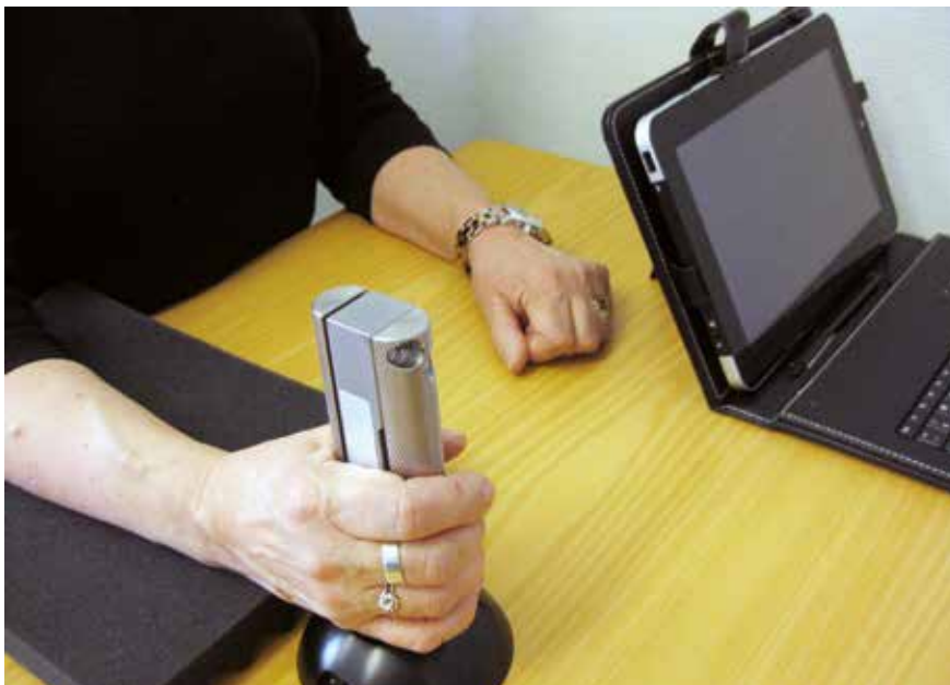
Handkraftmätaren GRIPPIT utvecklad av Brorsson & Nordenskiöld. En vidareutveckling av den ursprungliga Grippit. Foto: Ingrid Thyberg.
